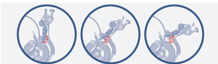
Abb. 109: Winkel der Kinnbedienung justieren
