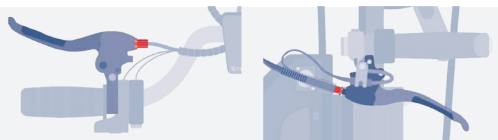
Abb. 81: Seilzug am Bremshebel nachspannen
