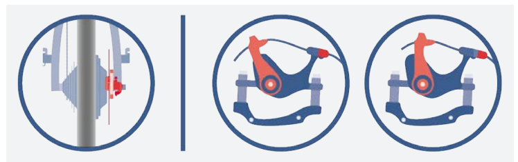
Abb. 75: Nachstellen an der Verstellerschraube
