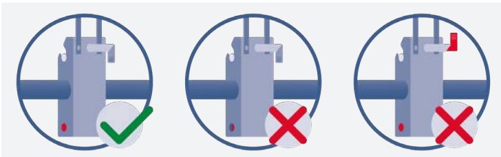
Abb. 43: Positiv- und Negativbeispiel: Bolzen vollständig ausgefahren und Sicherungsstift eingerastet
