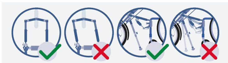
Abb. 27: Positiv- und Negativbeispiele der Rahmenposition
